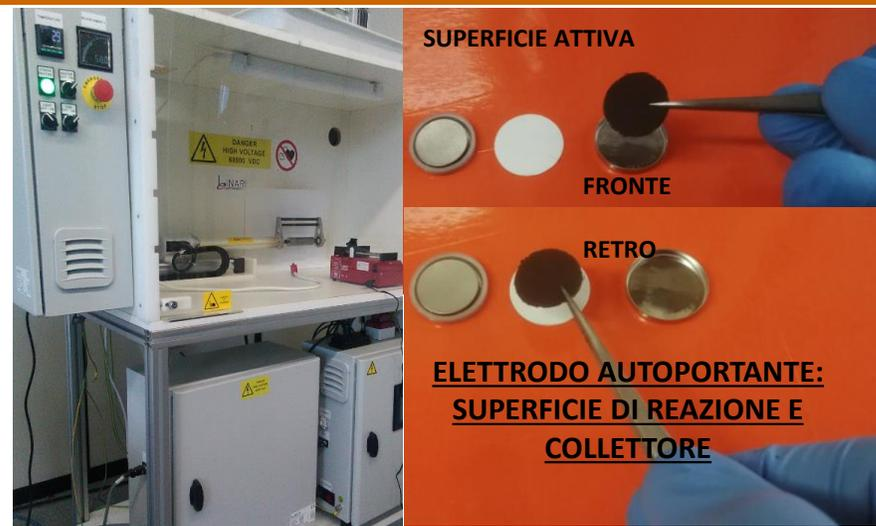
**L'elettrodo autoportante è privo di leganti o additivi quindi viene assemblato in coin cell senza alcun processo meccanico di miscelazione e stratificazione su un foglio di alluminio ed utilizzato come collettore di corrente**
